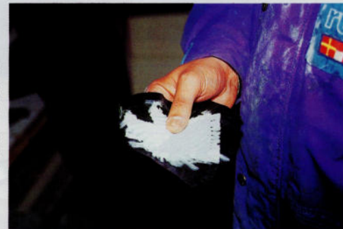
(Em cima), fase de acabamento da construção do primeiro kayak K1 desenhado pelo português Paulo Viana. (Ao lado), aspecto da fusão da fibra com o plástico
